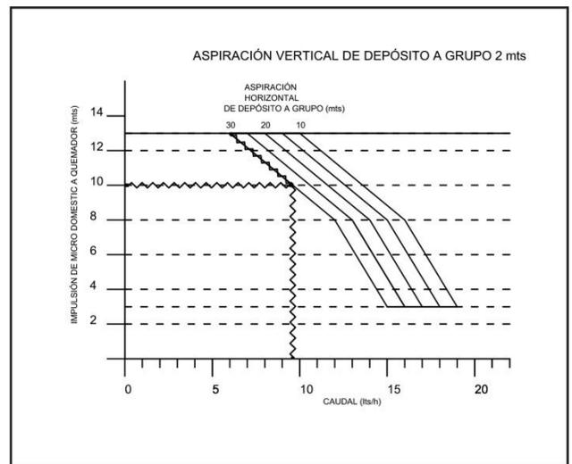
Ejemplo: Se tiene una distancia entre el depósito y donde se desea colocar el microdomestic de 2 metros en vertical y 30m. horizontal. La caldera se encuentra a 10 metros de altura entre esta y el micro domestic, por lo que podemos alimentar un quemador de 9 lts/h o menor.
