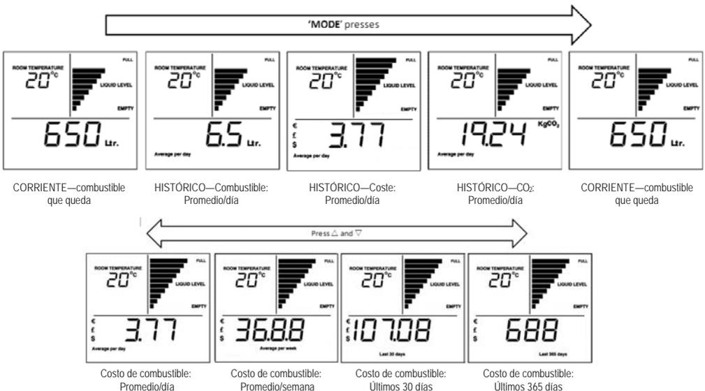
El display del Tankalert Eco Oil volverá automáticamente a la pantalla de información ACTUAL después de 30 segundos sin pulsarse ninguna tecla dentro de las pantallas de información HISTORICA. El valor máximo visualizable es 19.999 L.
