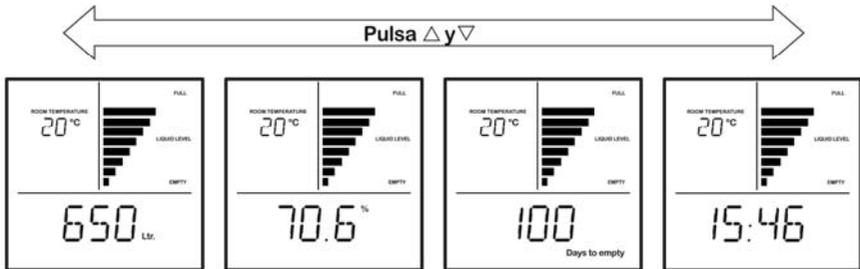
Durante aproximadamente una semana después de instalar el Tankalert Eco Oil, recoge datos de modo que puede calcular el "medio diario". Durante este período, la pantalla mostrará "-" cuando se muestre "Días para el vaciado" (en "parpadeo" se indica por el círculo en la imagen).
