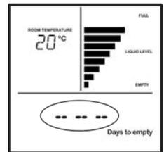
La pantalla también puede mostrar '—' si el display del Tankalert Eco Oil ha sido desconectado por algún tiempo. Cuando datos suficientes se hayan recogido, la pantalla volverá a su estado normal. Dependiendo de cuanto tiempo se ha desenchufado la pantalla volverá a su estado normal después de un período de entre pocas horas hasta un máximo de 1 semana.
