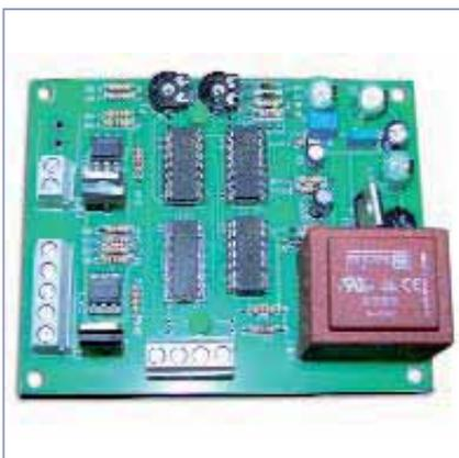
Determinar cual es el circuito que nos produce el mal funcionamiento del grupo, midiendo tensiones, continuidad, etc... ayudandonos del esquema eléctrico correspondiente.
